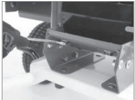
Fjern sikkerhetsboltene (17 mm) under kutteskiven.
