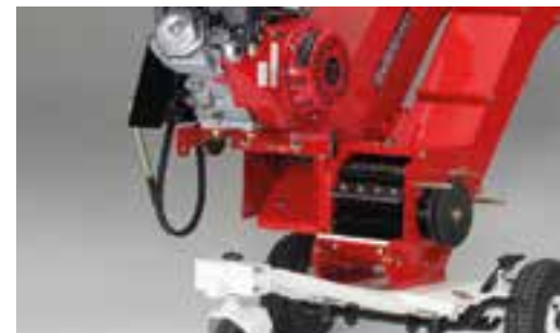
Serviceposisjon for rengjøring og skifting av kniver
