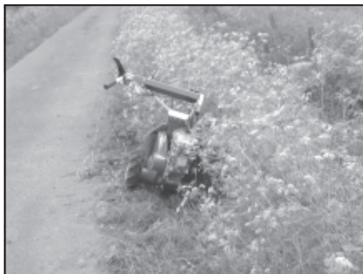
7. Bruk høydejusteringen på styret ved høy vegetasjon og ellers når nødvendig.
